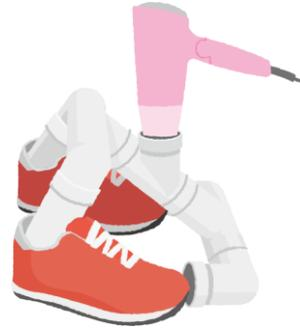
雨で靴が濡れてしまうことが多くなるこの時期。濡れた靴をそのままにしておくと、靴が傷むだけでなく、雑菌が繁殖してカビやニオイの原因にも。そこで今回は、ドライヤーの温風を靴に送り込む靴乾燥機のDIYに挑戦しませんか？用意するのは、塩ビパイプと塩ビパイプ用の三叉の継ぎ手2つ、Y型の継ぎ手1つ、それにL字型の継ぎ手4つ、バンド付き継ぎ手1つです。作り方は簡単。それぞれのパーツを接着剤でイラストのカタチに繋いで、バンド付きの継ぎ手にドライヤーをセットすれば完成。パーツの向きを変えれば、手袋なども乾燥することができます。ただし、靴の素材によっては熱に弱いもの、急乾燥に向かないものもあるため、ご注意ください。
